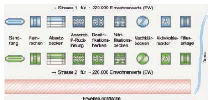
Abb. 1: Schematischer Aufbau der Kläranlage Steinhäule [1]
